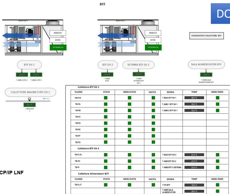
Rete del sistema di controllo e supervisione degli impianti ausiliari LINAC E BTF
