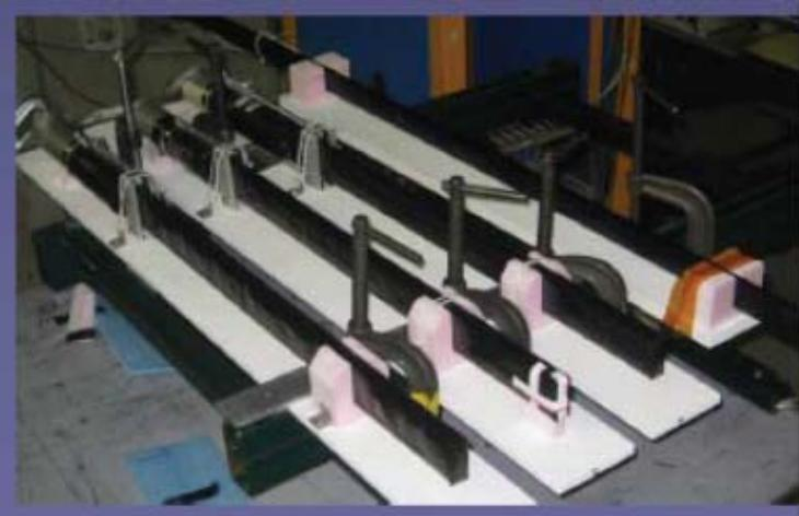
Preparazione di barre di scintillatori estrusi di diversa lunghezza da 1 a 3 m) per i test su fascio di pioni (120 GeV/c) al FNAL.
