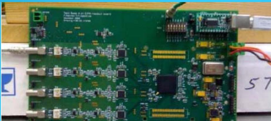
Prototipo a 4 canali di scheda di amplificazione/acquisizione usata nei test su fascio a FNAL. Ogni canale (accoppiato in A/C con il SiPM) contiene amplificatore, ADC a 12 bit con un campionamento di 210 M SPS, memoria per 8K punti e uscita USB. Dotata anche di generatore di tensione di bias fino a 100 V con controllo dell'offset e monitor di corrente per ogni canale.
