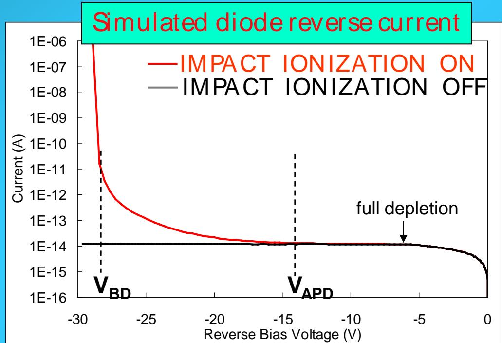
$V < V_{APD}$   $\Rightarrow$  photodiode
