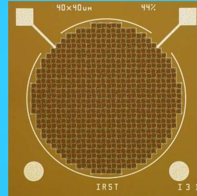
**Circular:  $\varnothing 1.2 \text{ mm}$
