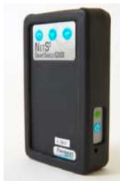
Personal radiation detectors (PRD): piccoli dispositivi indossabili che allertano l'operatore della presenza di materie radioattive per intercettare traffici illeciti. Alcuni sono spettrometrici.
