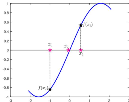
4) Denotiamo con  $x_2$  l'intersezione della retta tangente con l'asse delle ascisse.
