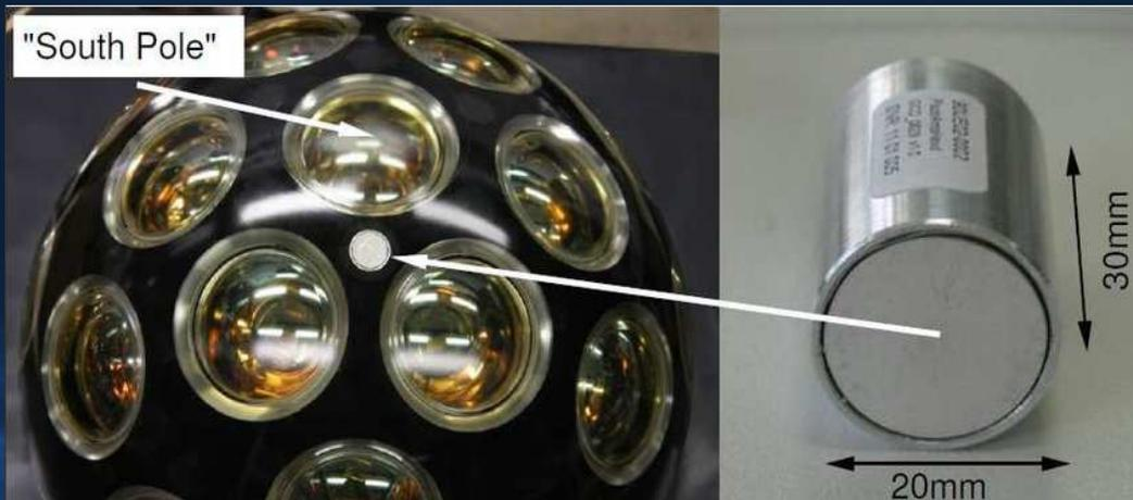
Un piccolo microfono in ogni modulo ottico
