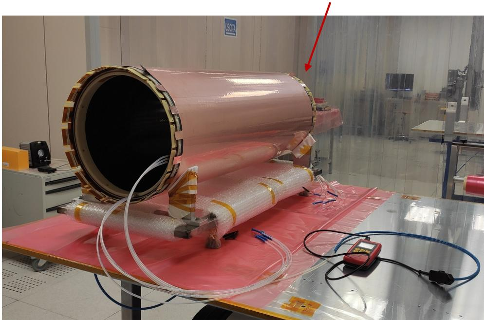
Test effettuato ieri: piccola perdita rilevata nella zona indicate dalla freccia (arco di ~15 cm)
