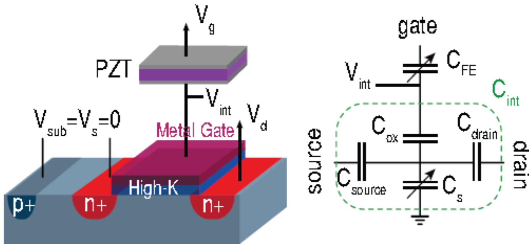
**Sfida tecnologica nel combinare il processo produttivo a alta temperatura della Perovskite con quello a *bassa* temperatura dei circuiti integrati**
