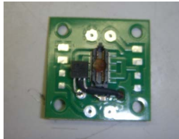
Vista dal lato SiPM
