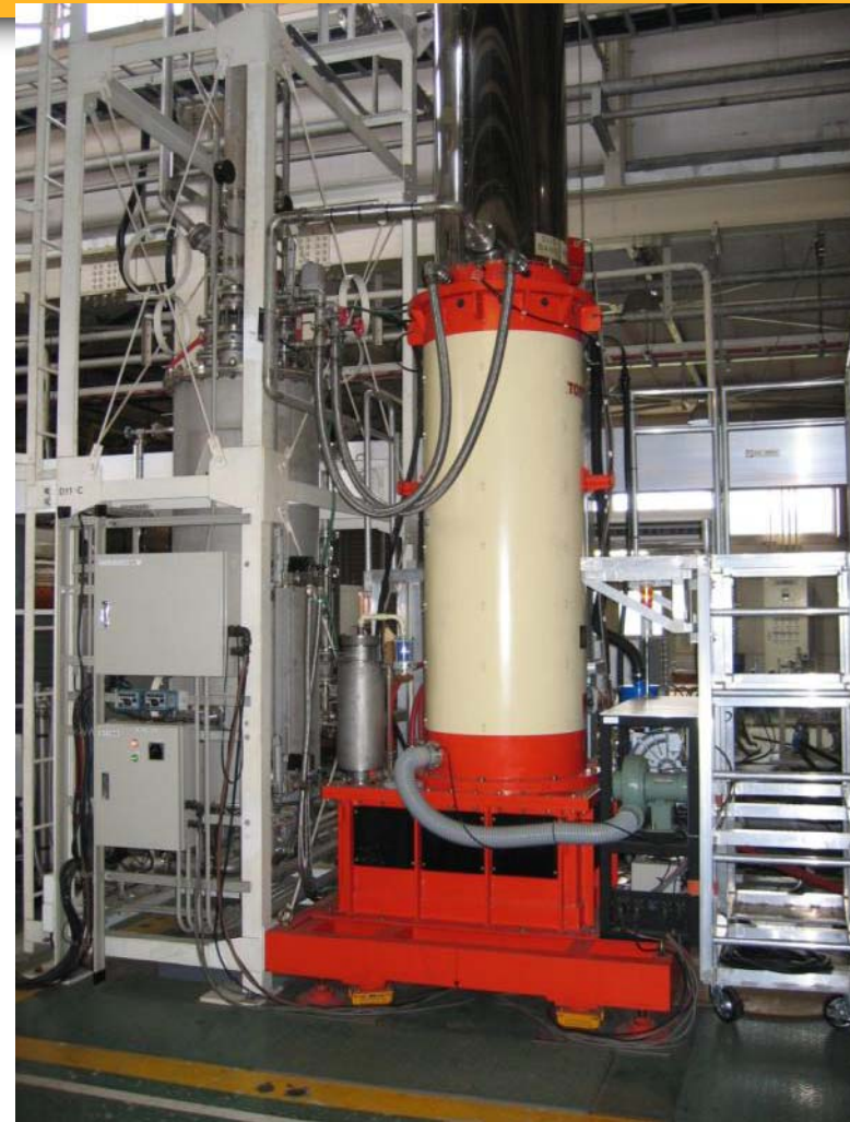
1.2MW CW klystron
