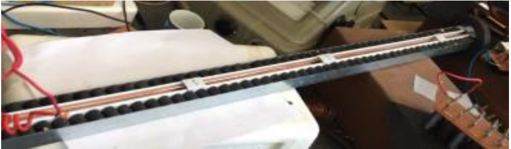
Fig. 4. Injector of the Acoustoplasma Bunches ( d=4-5 cm., L=1 m.)
