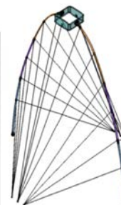
Fig. 4 elementi di ancoraggio (chain plates) delle funi sul telescopio: tre di questi per ogni lato del telescopio, quello verde per 5 funi centrali, quello grigio per 4 funi a destra e sinistra della centrale. 13 funi per lato, 26 in totale.
