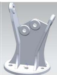
Fig. 4 elementi di ancoraggio (chain plates) delle funi sul telescopio: tre di questi per ogni lato del telescopio, quello verde per 5 funi centrali, quello grigio per 4 funi a destra e sinistra della centrale. 13 funi per lato, 26 in totale.
