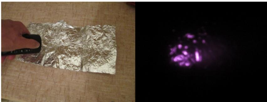
Il **foglio di alluminio**, come tutti i metalli, ha la proprietà di **riflettere le onde elettromagnetiche**, non solo nel visibile, ma anche nell'infrarosso. **Avvolgendo la bottiglia con la pellicola di alluminio l'energia irradiata in radiazione IR dall'acqua calda viene pertanto riflessa.**
