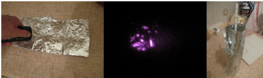
Il **foglio di alluminio**, come tutti i metalli, ha la proprietà di **riflettere le onde elettromagnetiche**, non solo nel visibile, ma anche nell'infrarosso. **Avvolgendo la bottiglia con la pellicola di alluminio l'energia irradiata in radiazione IR dall'acqua calda viene pertanto riflessa.**
