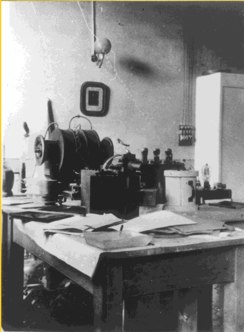
Un magnete e il cosiddetto “segno romano”, la camera di ionizzazione connessa ad un elettrometro usata per la misurazione della radioattività.
