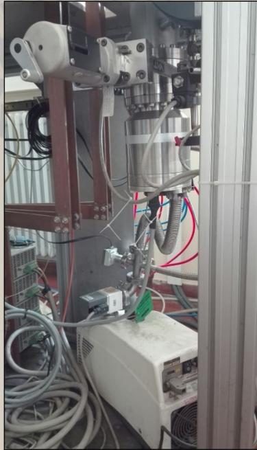
Pompa e turbopompa
