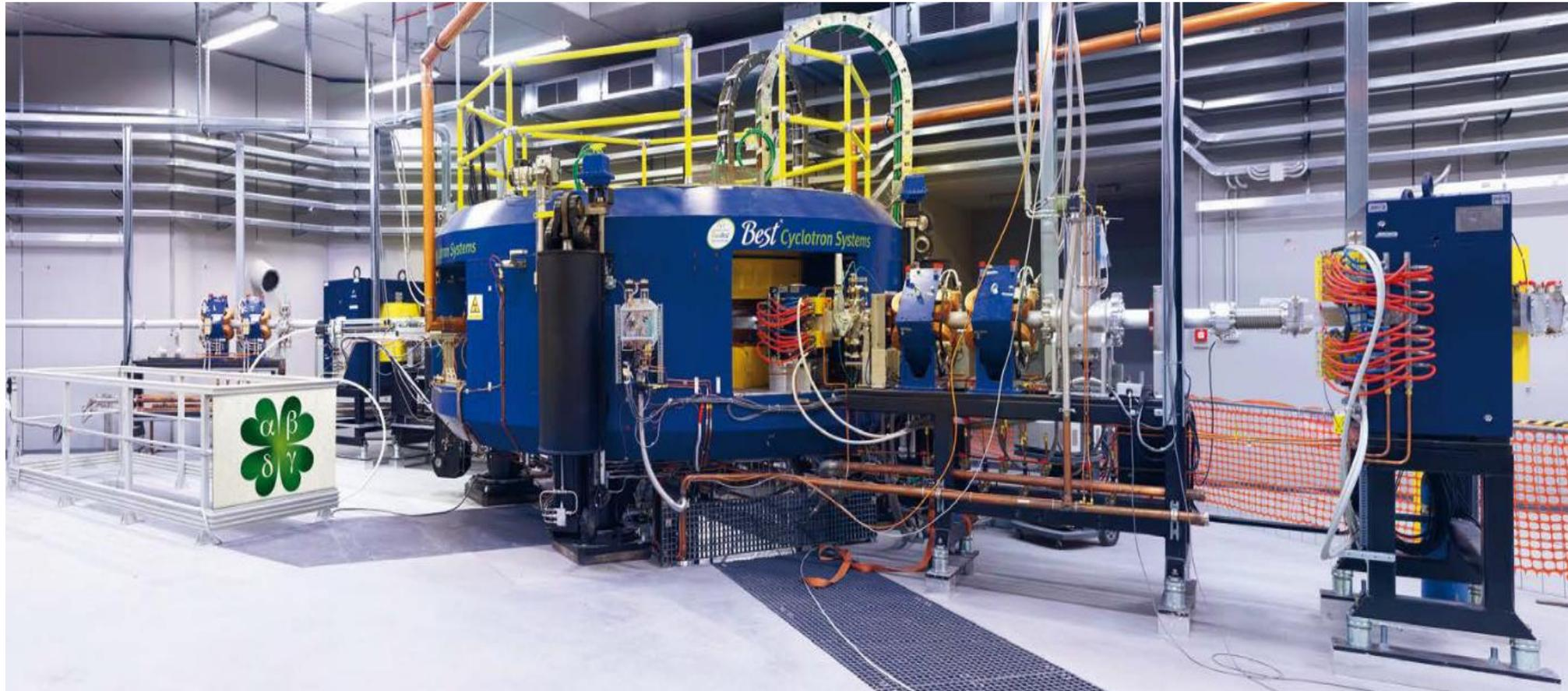
70  $\mu$ A 70 MeV, proton driver installato a LNL nel 2016 per il progetto SPES
