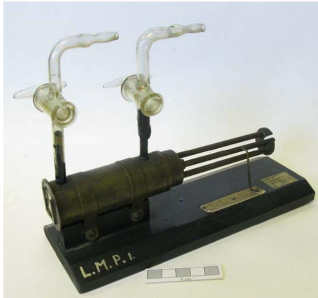
In questa apparecchiatura, gli atomi di azoto sono stati convertiti in atomi di ossigeno, in caso di collisione con particelle alfa ( ${}^4\text{He}$ ) da una sorgente all'interno del tubo orizzontale chiuso. Protoni espulsi dall'azoto durante la formazione di ossigeno sono stati rilevati alla finestra rettangolare alla fine del tubo
