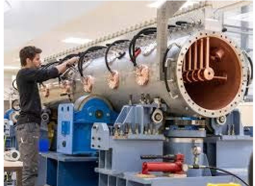
Un moderno DTL: costruito al CERN per il progetto LINAC 4, opera a 352 MHz , ed accelera ioni H- da 3MeV a 50 MeV
