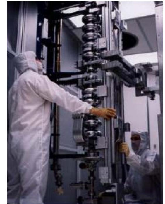
Assemblaggio in camera pulita di una cavità SC.
