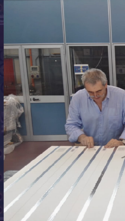
Produzione camere per CRT a LNF [NU_AT_FNAL]
