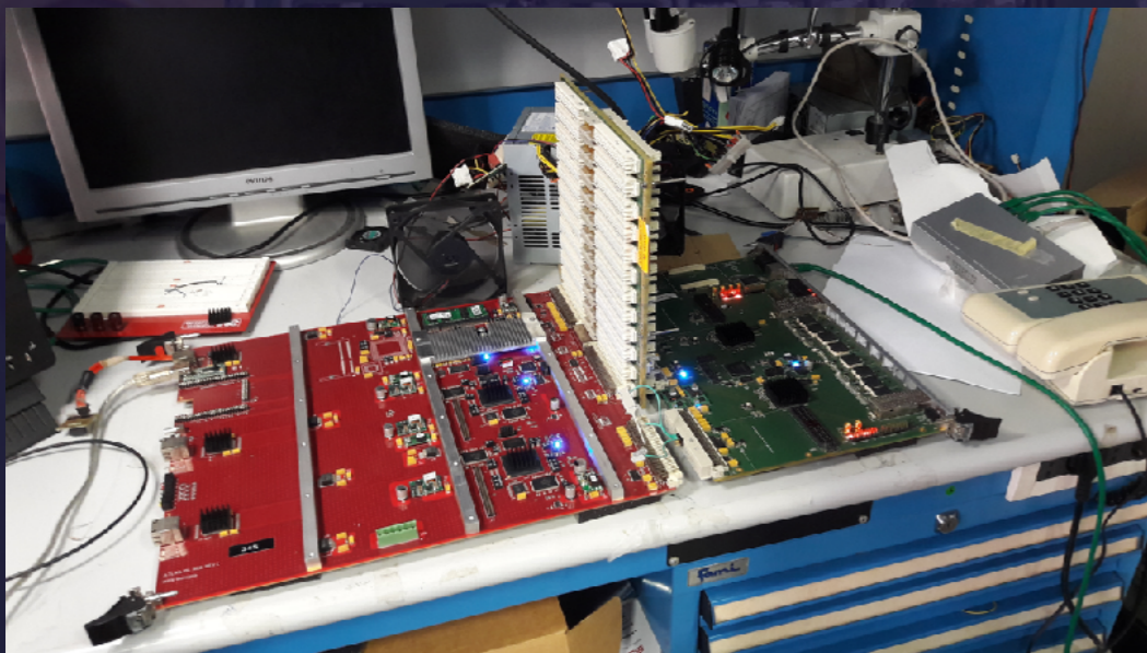
Setup di test e riparazione schede ROD [ATLAS]
