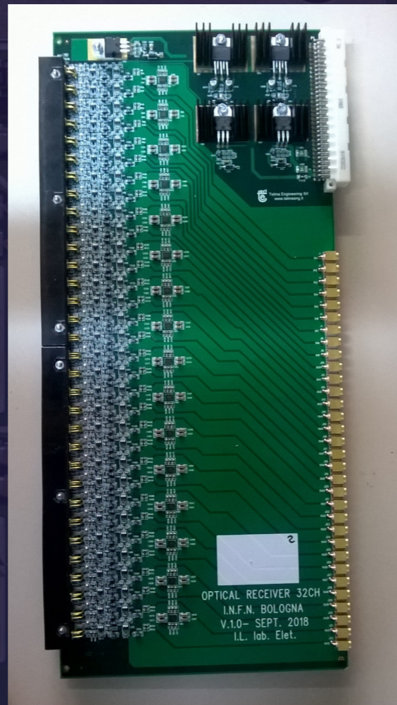
OPTICAL_RECEIVER_32CH [DARKSIDE] Formato 9U (160x360) 32 ingressi ottici analogici 32 uscite su connettori MCX 64 amplificatori operazionali
