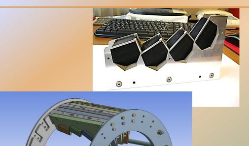
Disegni di progetto di una sliding chamber ,una camera che permetterà di avere fasci poco intensi a partire da un fascio rilasciato dall'acceleratore di Legnaro. Il fascio infatti incide su un bersaglio, producendo un fascio di molto minore intensità in modo che possa essere utilizzato da una "active target" (Actar)
