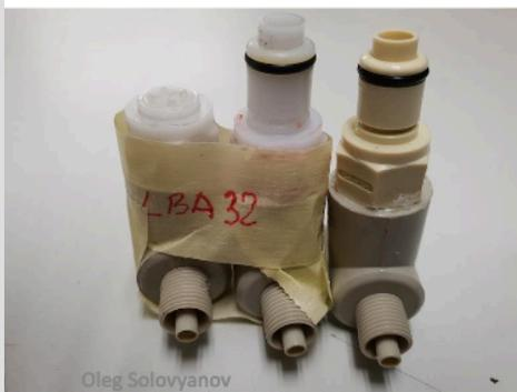
Cooling system: remotely controlled valve per isolare un singolo modulo nel loop (fino a 11 moduli nel loop)
