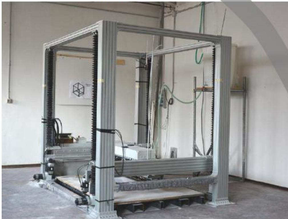
La stampante è stata progettata e costruita da Desamanager, così come la progettazione e l'implementazione dei software di slicing e di funzionamento.
