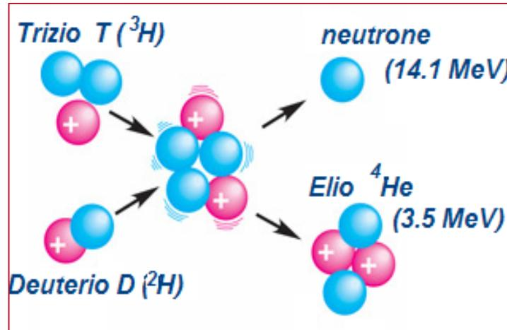
Energia di reazione  $\gg$  energia di ionizzazione  $\Rightarrow$  il combustibile è allo stato di **plasma** (fluido completamente ionizzato).
