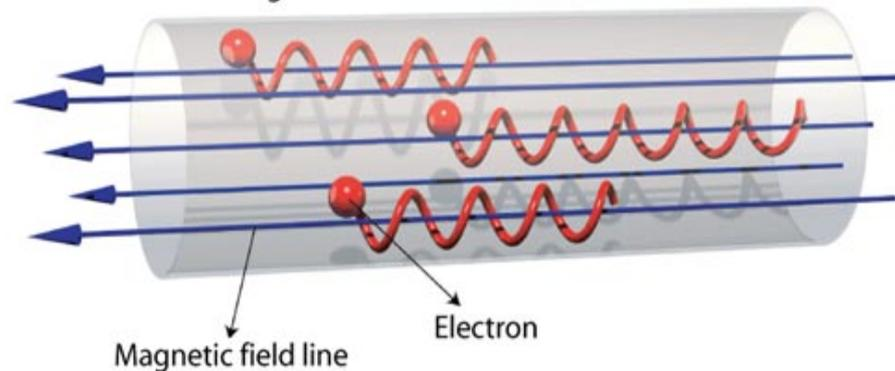
Le particelle cariche seguono orbite a spirale attorno alle linee di campo.
