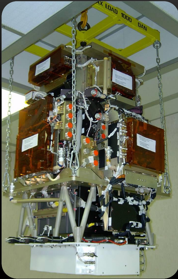
Installazione del telescopio PAMELA a bordo del satellite russo Resurs-DK1, presso il cosmodromo di Baikonur (Kazakhstan)
