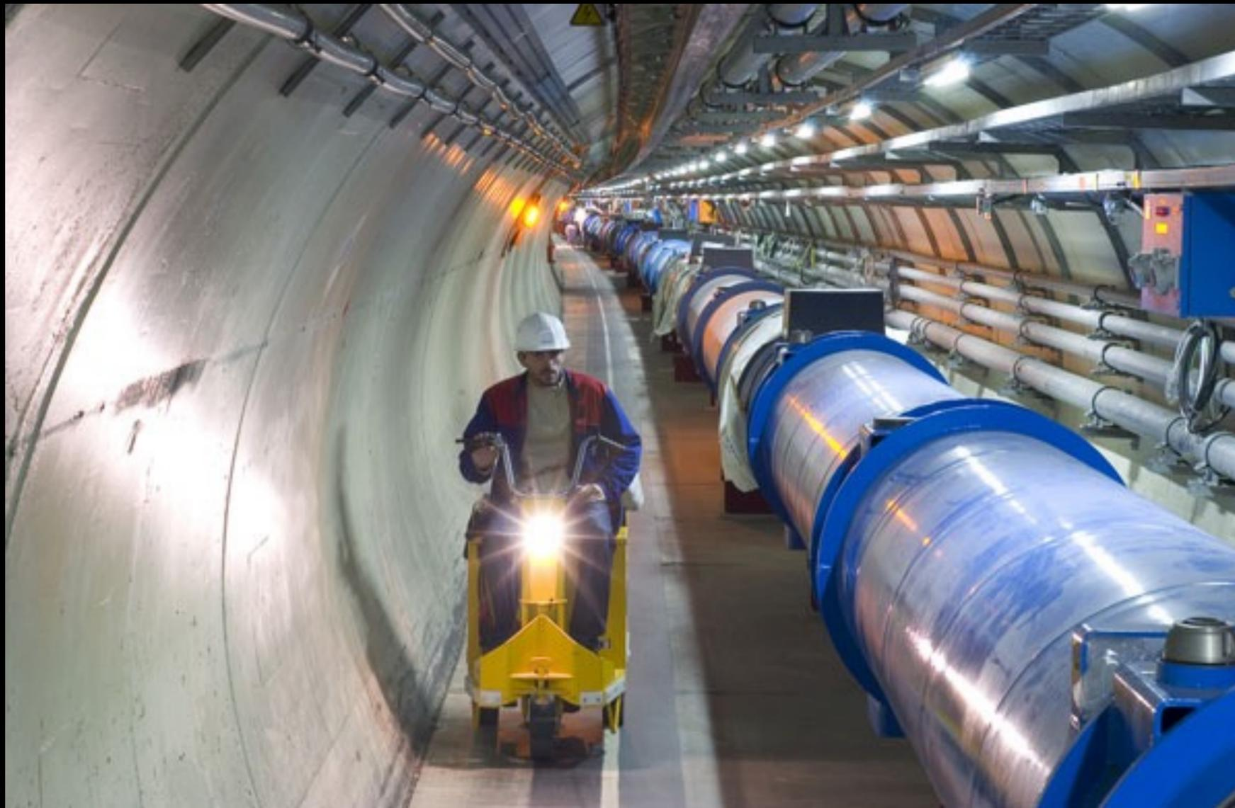
Fasci di protoni percorrono in verso opposto un circuito di 27 Km con una velocità pari al 99.999999% della velocità della luce
