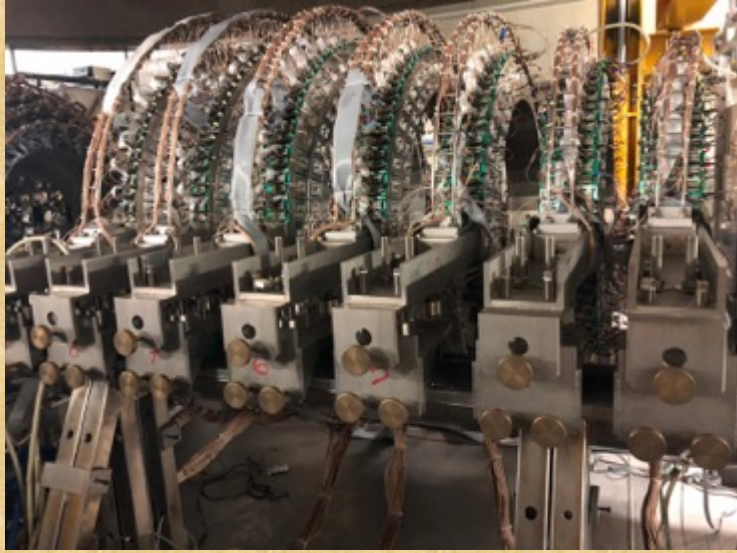
Chimera: fisica stroparticellare Rivelatore part. cariche emesse da collisioni nucleari
