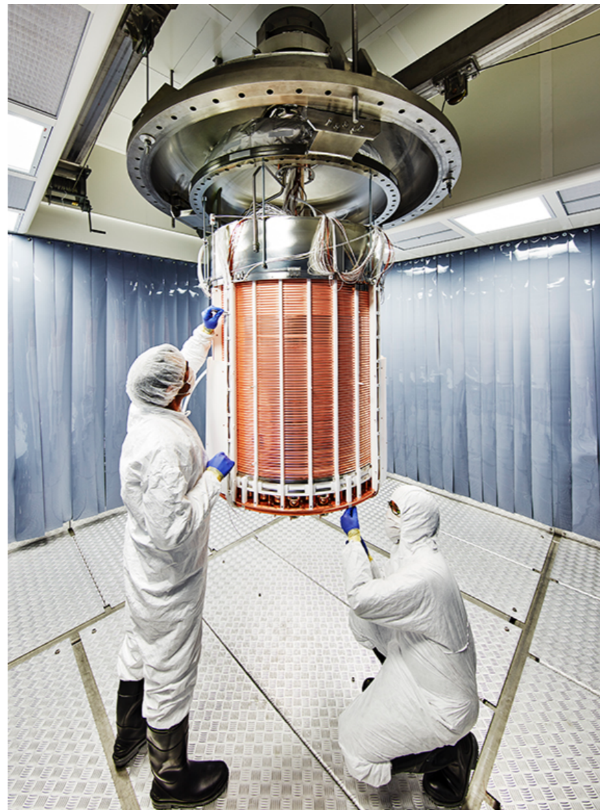
Installation della TPC in camera pulita in galleria.
