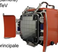
GCT è un prototipo di camera per SST che ha uno specchio principale di 4 m di diametro. [3]
