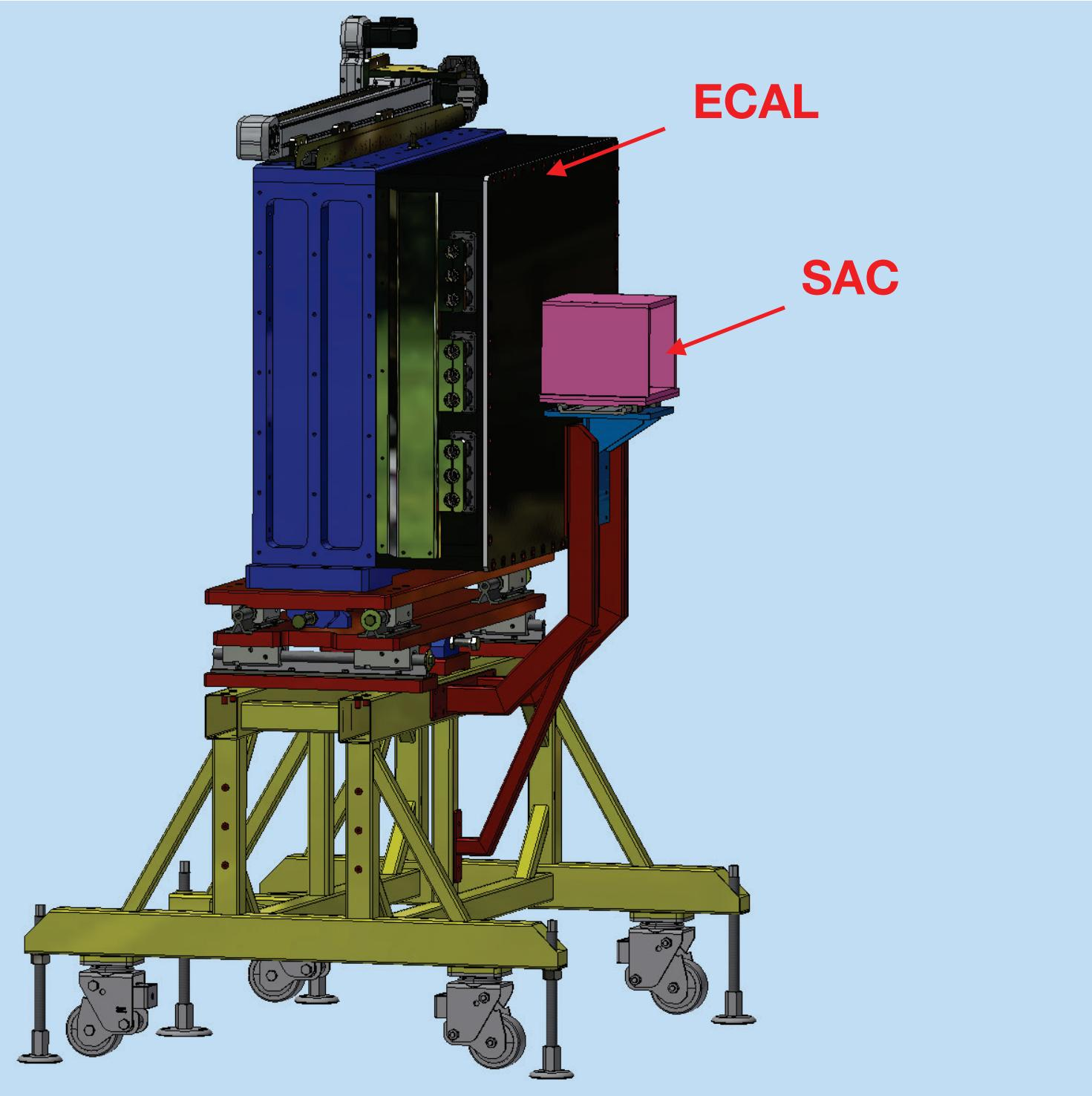
FIGURE 1. ARRANGEMENT OF THE PADME CALORIMETER SYSTEM
