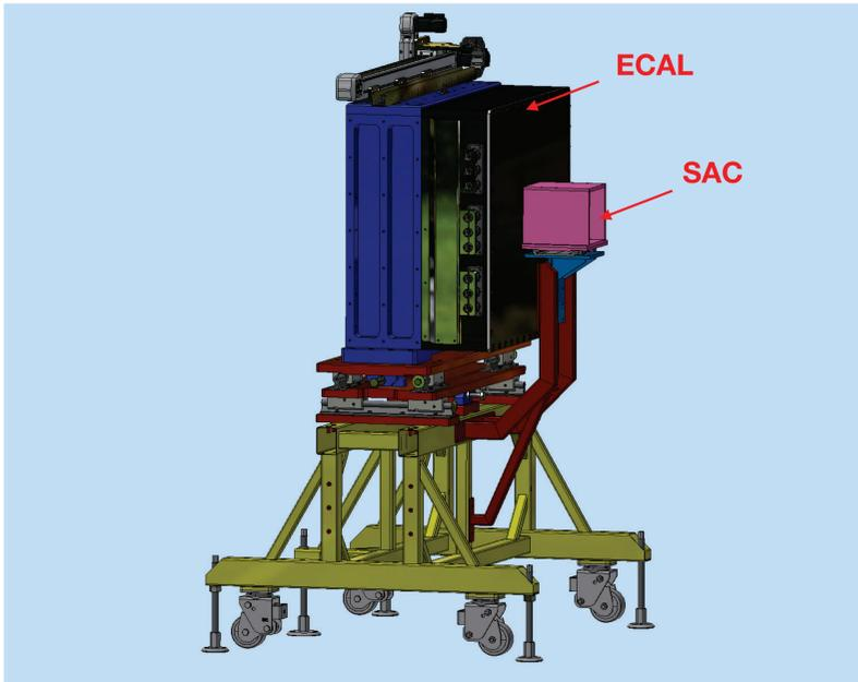
FIGURE 1. ARRANGEMENT OF THE PADME CALORIMETER SYSTEM
