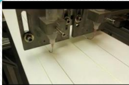
Incollaggio delle fibre e dei SiPM sulle barre di scintillatore
