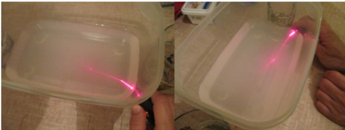
La luce del laser, incidendo con un angolo maggiore di un *angolo critico*, viene **totalmente riflessa** e questo si ripete lungo tutto il percorso del fascio di luce. Questo fenomeno si chiama **riflessione totale** e viene sfruttato per "guidare" la luce *senza perdite* lungo il percorso che si desidera, ad esempio attraverso **fibre ottiche**.
