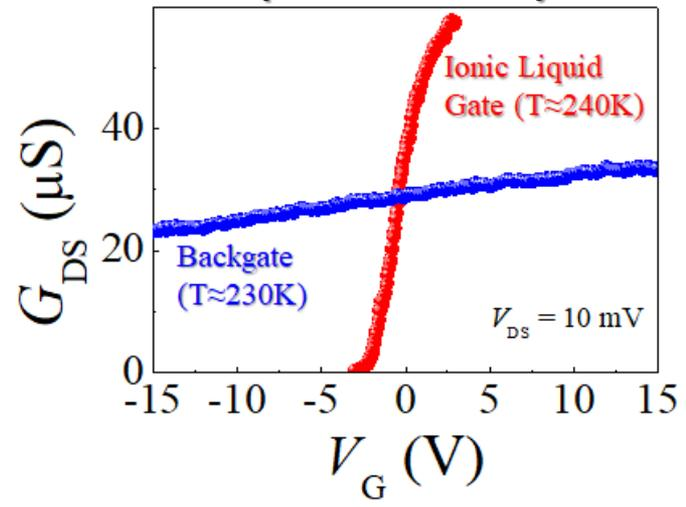
$$C_{\text{LIQUID GATE}} \approx 30 * C_{\text{BG}}$$
