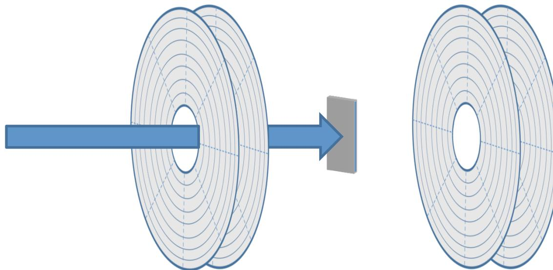
Il diametro interno può essere ampio a sufficienza, per evitare che il fascio colpisca il rivelatore.
