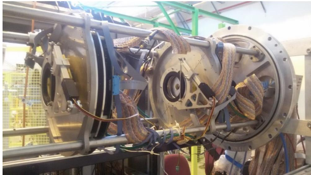
DETECTOR TYPE: SILICON MICROSTRIP TRAPEZOID OR WEDGE SHAPE STRUCTURE
