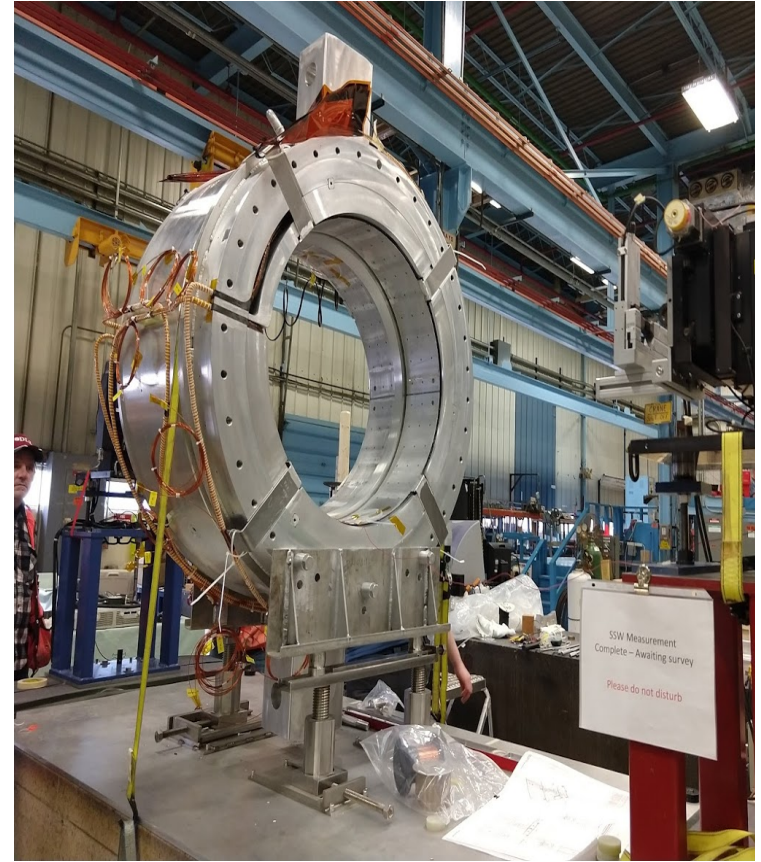
Modulo 1 durante test dimensionali a Fermilab
