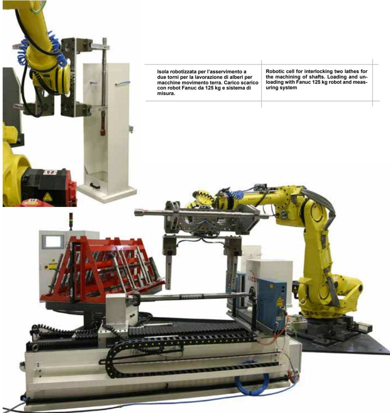
Isola robotizzata per l'asservimento a due torni per la lavorazione di alberi per macchine movimento terra. Carico scarico con robot Fanuc da 125 kg e sistema di misura.
