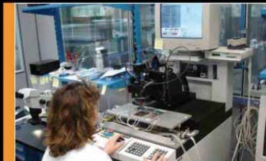
1. Operatrice al lavoro sulla macchina che esegue le microscadature e ultrasuoni sui componenti del tracciatore a silicio.
