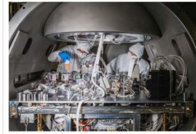
Fisici lavorando ad un banco ottico sospeso (Photo: © Cyril FRESILLON/Virgo/CNRS Photothèque)
