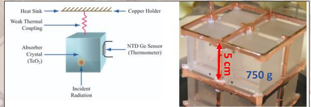
Un criostato a diluizione mantiene il sistema a  $T \cong 10 - 15$  mK
