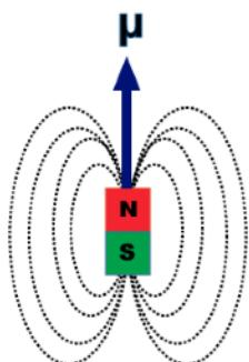
$$\vec{\mu} = \frac{g}{2} \frac{e}{m} \vec{S}, \quad \vec{S} = \frac{\hbar}{2} \vec{\sigma}$$
