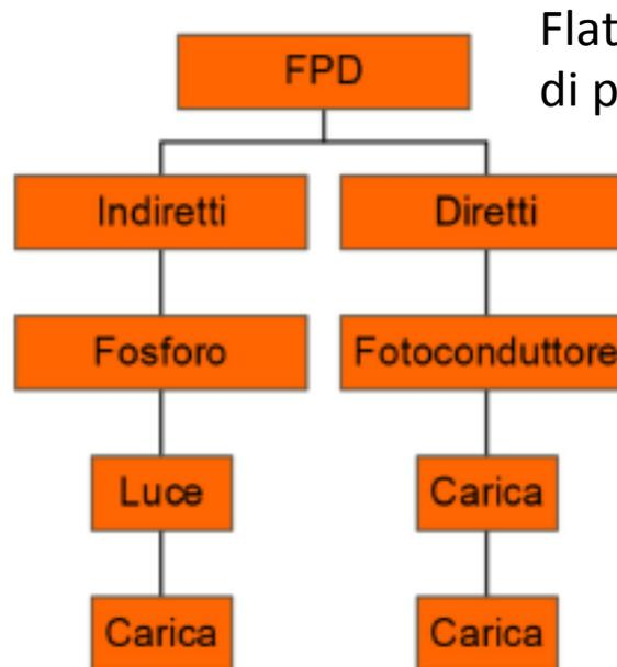
Flat panel detector (matrice 2D di pixel)
