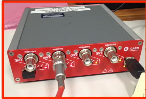
HV Power Supply (- 800 V ÷ + 800 V)
