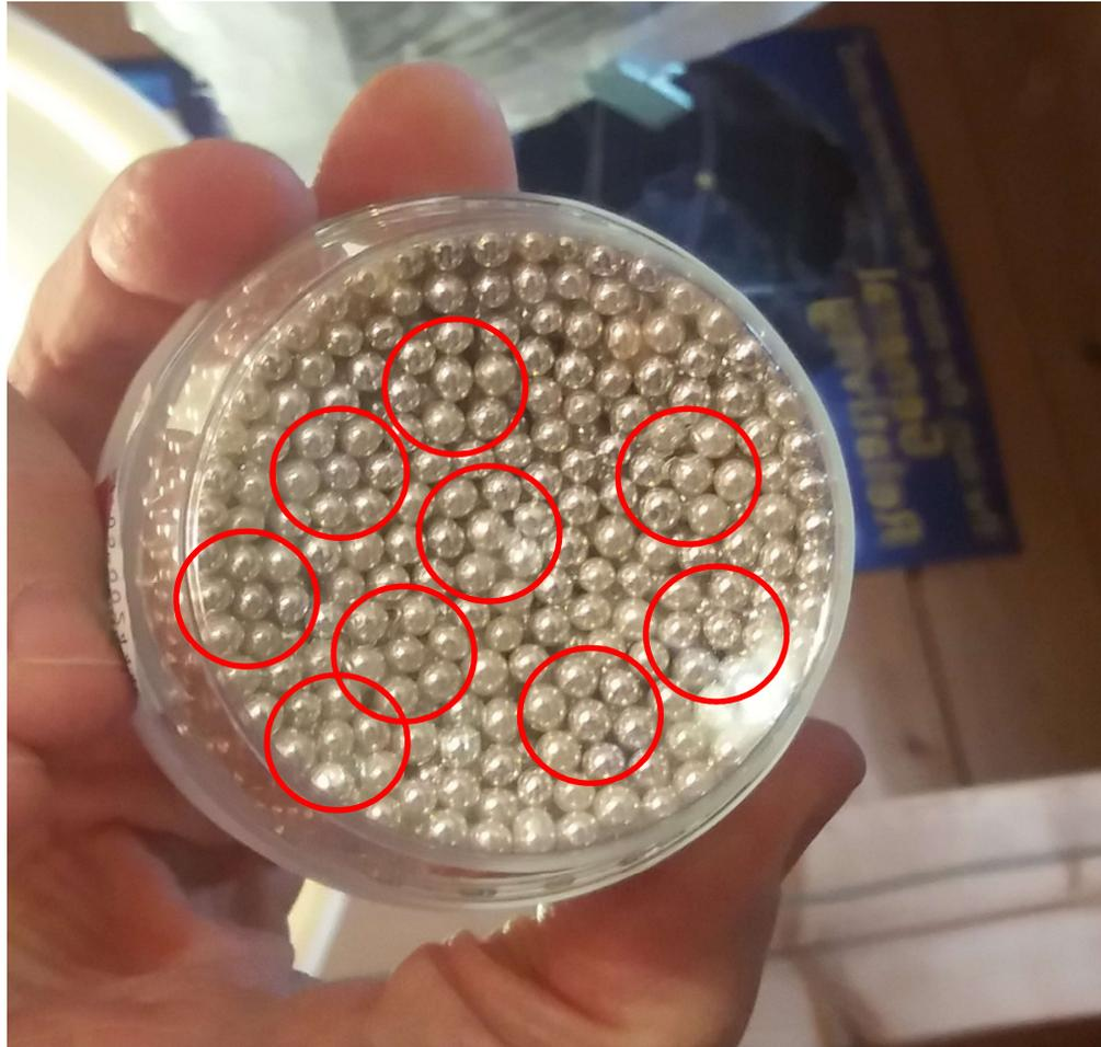
Le sferette si impacchettano spontaneamente sul fondo concavo di un recipiente, formando una struttura triangolare compatta quasi-regolare.
