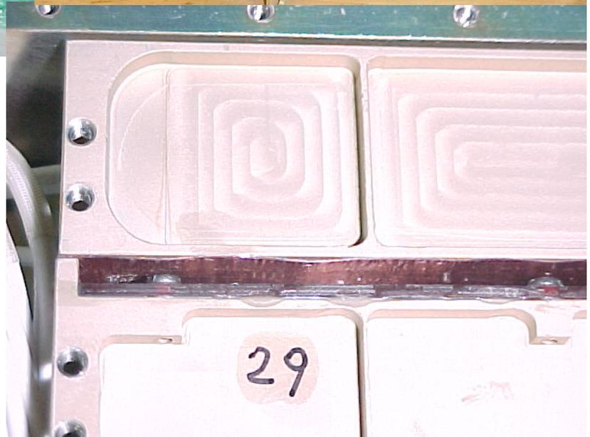
Alimentatore alta tensione (*brick*): costruzioni scatole per elettronica con utilizzo di elettroerosione e fresa
