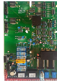
Schede elettroniche per convertitori elettronici di potenza, acquistate o progettate e costruite in laboratorio.
