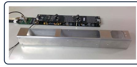
Fig. 10: ASIC TARGET-7 con struttura di supporto per accoppiamento con la meccanica del piano focale di pSCT.
