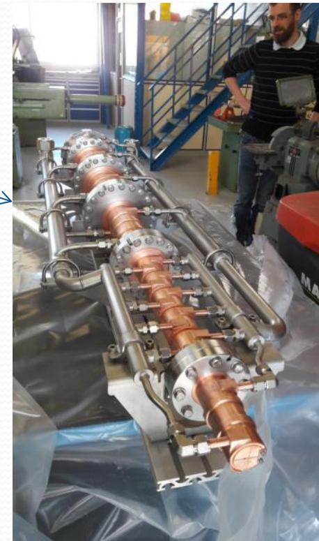
Tests vide arrêt faisceau principal avant installation (4/2017)
