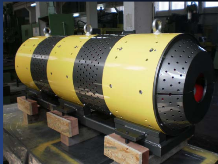
The triplet of quadrupole lenses 11K30-700 (N&V, Romania)
