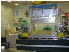
Ο καθαρός χώρος ελεγχόμενων συνθηκών (clean room) για την κατασκευή των θαλάμων μιονίων στο Εργαστήριο Εργασιομηχανιών και Διομορφωτικής Μηχανολογίας
