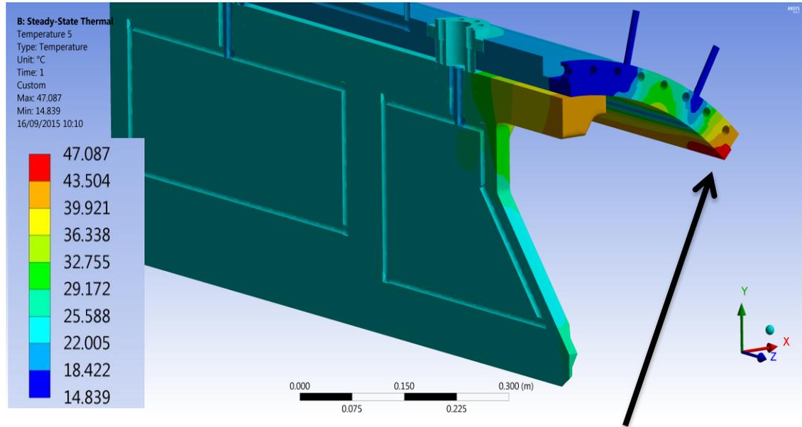
$T_{max} = 47^\circ\text{C}$ ,  $v=3\text{m/s}$
