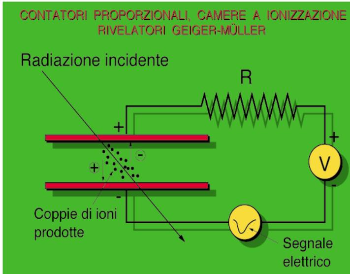
Si sfrutta il processo di **ionizzazione** che avviene nel **gas**, contenuto in una camera, per effetto dell'interazione della radiazione. Le cariche (**elettroni/ioni**) liberate nel gas vengono raccolte da una coppia di elettrodi e producono un segnale elettrico.
