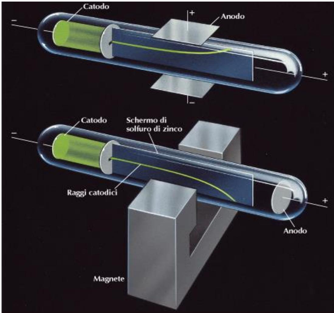
La deviazione di un raggio catodico da parte di un campo elettrico.
