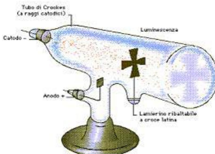
Gli esperimenti mettevano in evidenza che la radiazione che usciva dal catodo non poteva essere della stessa natura della luce, perché una forma di energia immateriale non sarebbe stata in grado di spingere un mulinello a pale; essa inoltre, incontrando un ostacolo, avrebbe dovuto generare, oltre all'ombra, un alone di penombra molto ben visibile. Le evidenze sperimentali suggerivano che doveva trattarsi di uno **sciame di corpuscoli**.
