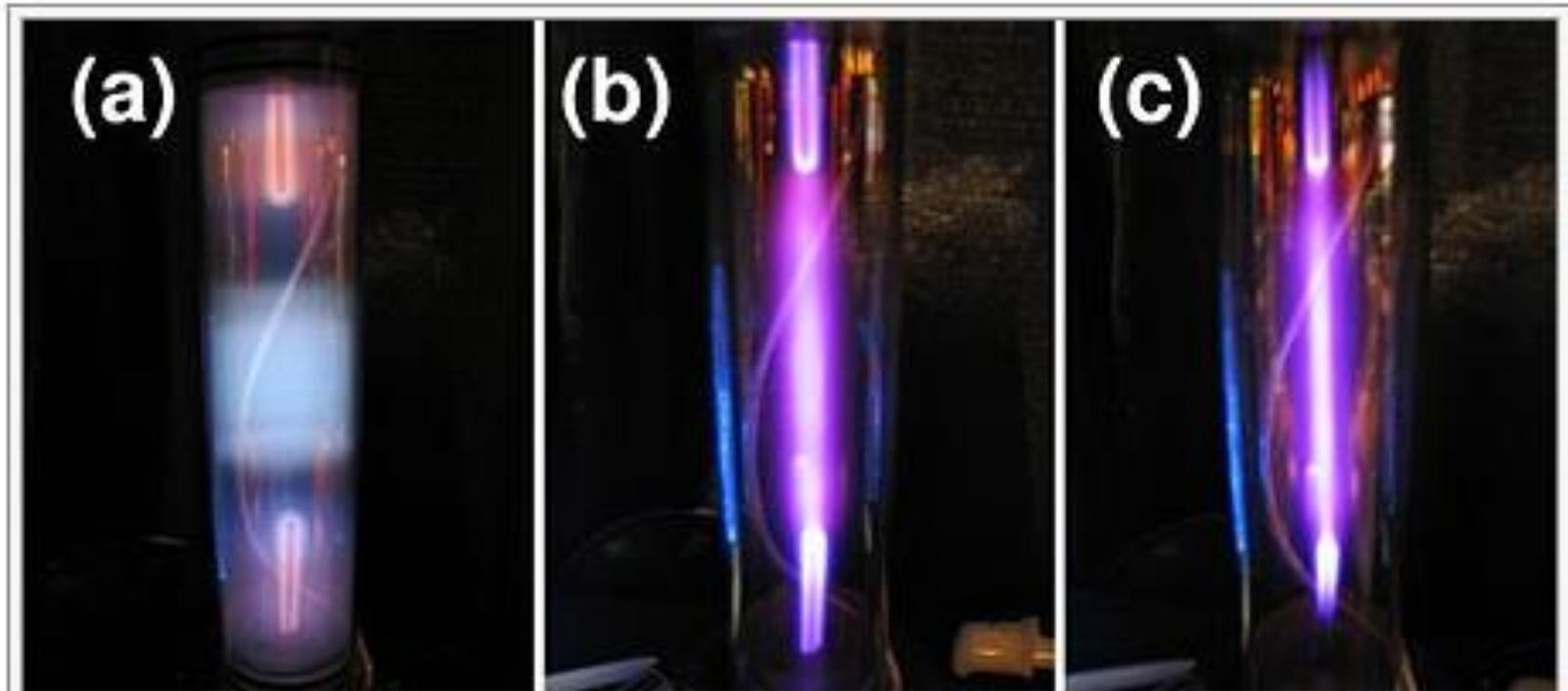
La transizione dalla scarica a bagliore all'arco si può ottenere semplicemente aumentando la **pressione** del gas di riempimento, come nell'esempio qui mostrato: da (a) a (c) la scarica passa dalla glow, dove il bagliore occupa tutto il tubo da vuoto, all'arco, dove la scarica invece assume gradualmente la forma di una scintilla, e occupa solo la parte centrale del tubo. Gas:argon.
