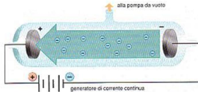
Quando il tubo è pieno d'aria, anche applicando agli elettrodi una differenza di potenziale molto elevata non si osserva alcun fenomeno in quanto **l'aria** (e più in generale i gas) a pressione normale, **non conduce l'elettricità**.
