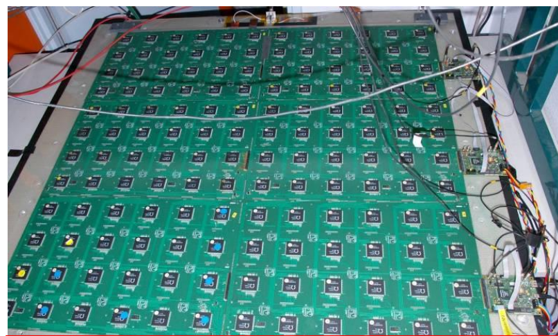
1m 2 RPC detector for ILC DHCAL [I. Laktineh]
