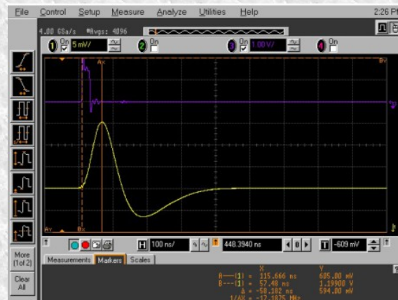
GAIN HGPRES=0 SSTEME=6 VIN=2.2mV
